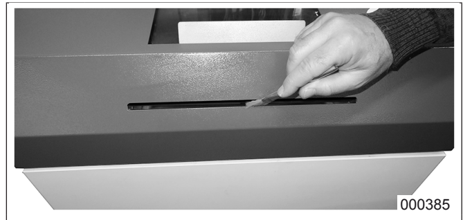
Abb. 11 Reinigung der Fotozellen
