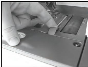
4 Entfernen Sie eingeklemmte Kuverts.
