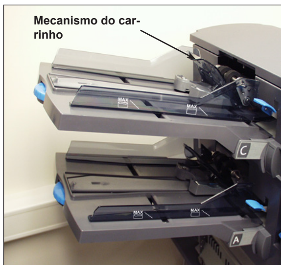
Figura 2.3.2: Bandeja de inserção
