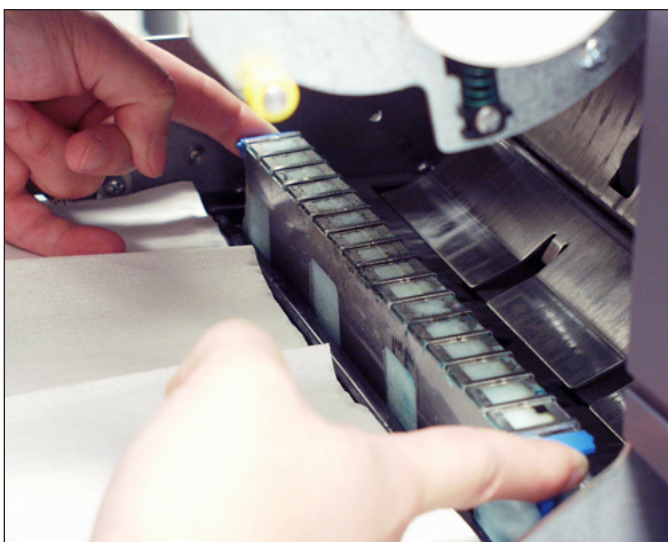
Figura 5.3: Remoção do cartucho da espuma usado
