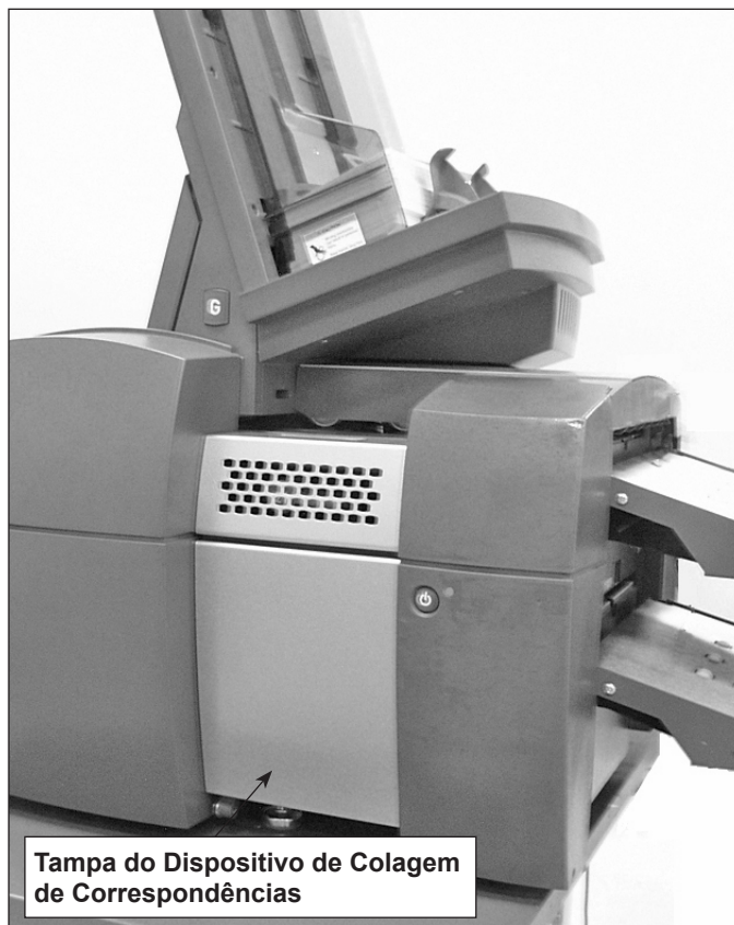
Figura 7.8: Módulo do Dispositivo de Colagem de Correspondências (mostrado aqui com um HCEF)
