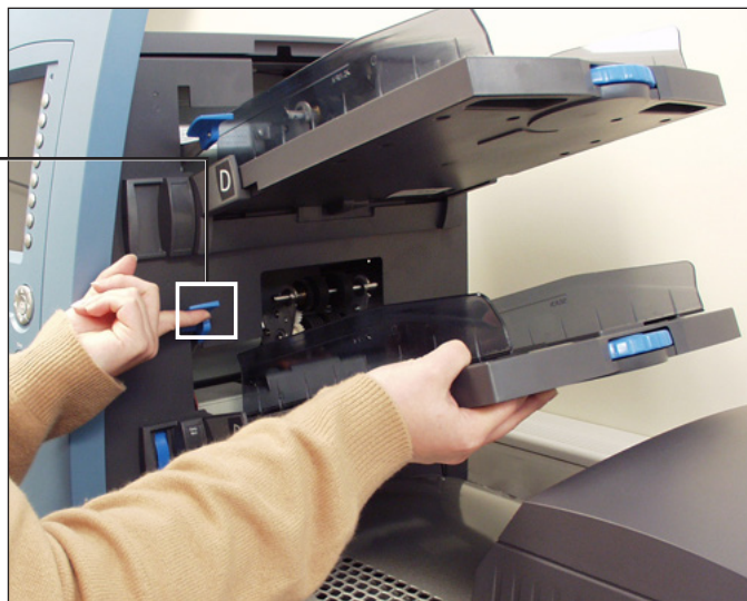
Figura 3.1.1: Levante o Separador e deslize a Bandeja nos suportes de fixação da bandeja.
