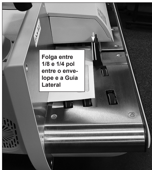
Figura 7.16: Folga entre o envelope e a Guia Lateral
