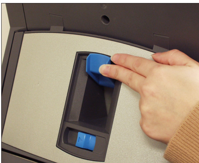
Figura 3.8.1: Empurre para cima a Alavanca do Vão do Separador
