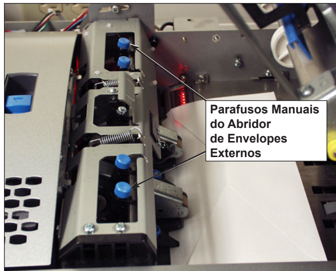
Figura 3.9.2: Locais do Abridor de Envelopes Externos
