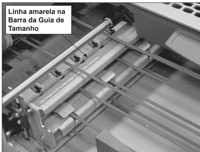
Figura 7.7: Barra da Guia de Tamanho
