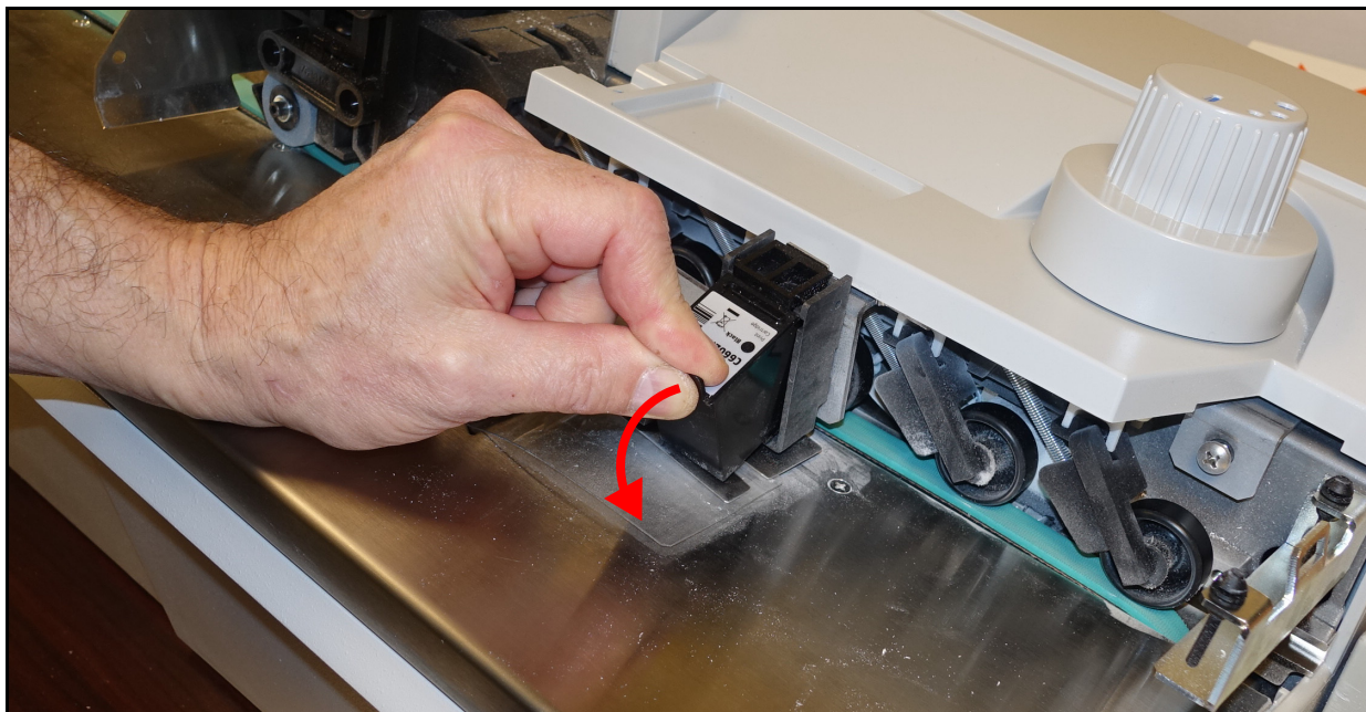
Abbildung 4-17: Entfernen der Druckerpatrone
