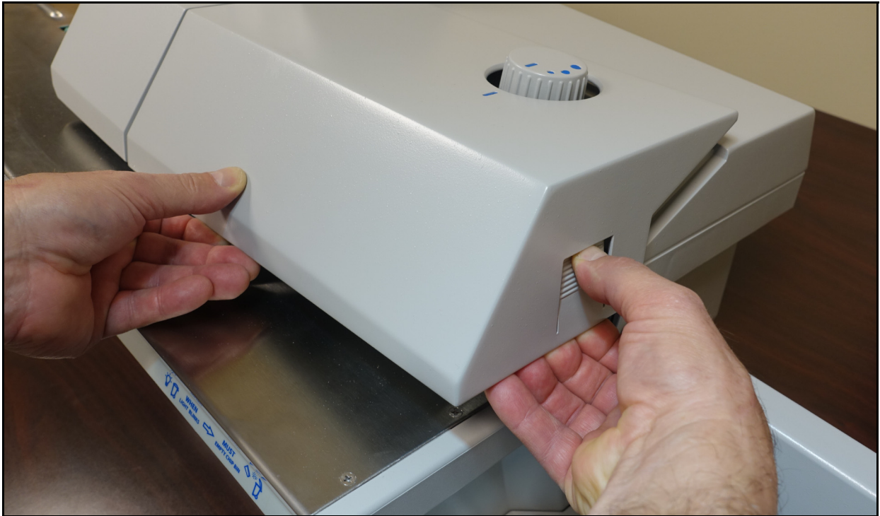
Abbildung 2-9: Die Verriegelung löst aus wenn die obere Abdeckung entfernt wird
