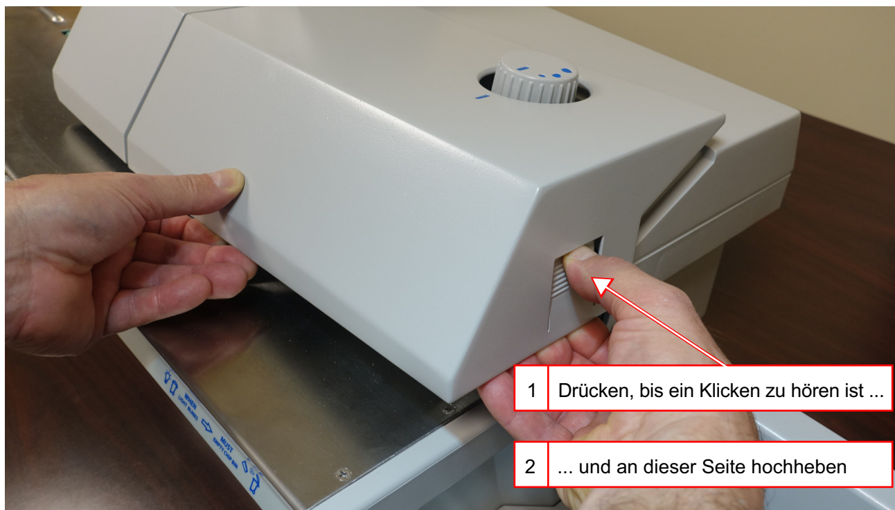
Abbildung 4-14: Drücken des Entriegelungsknopfes
