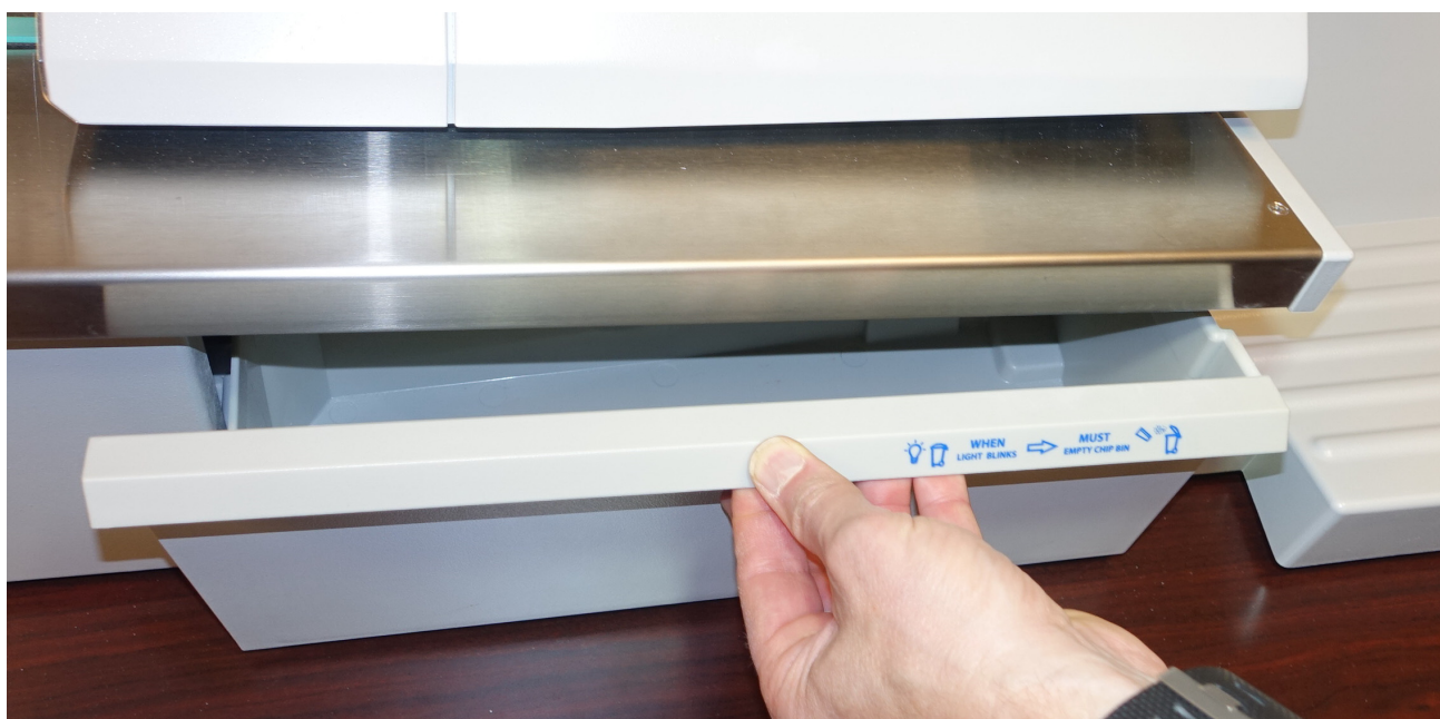
Abbildung 2-8: Auslösung der Verriegelung bei Entfernung des Fachs
