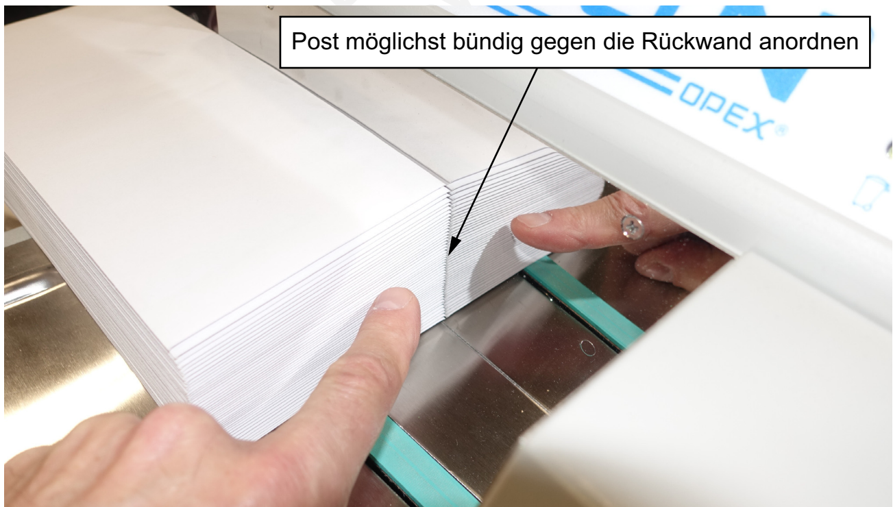
Abbildung 4-7: Post bündig an der Einzugsfachwand
