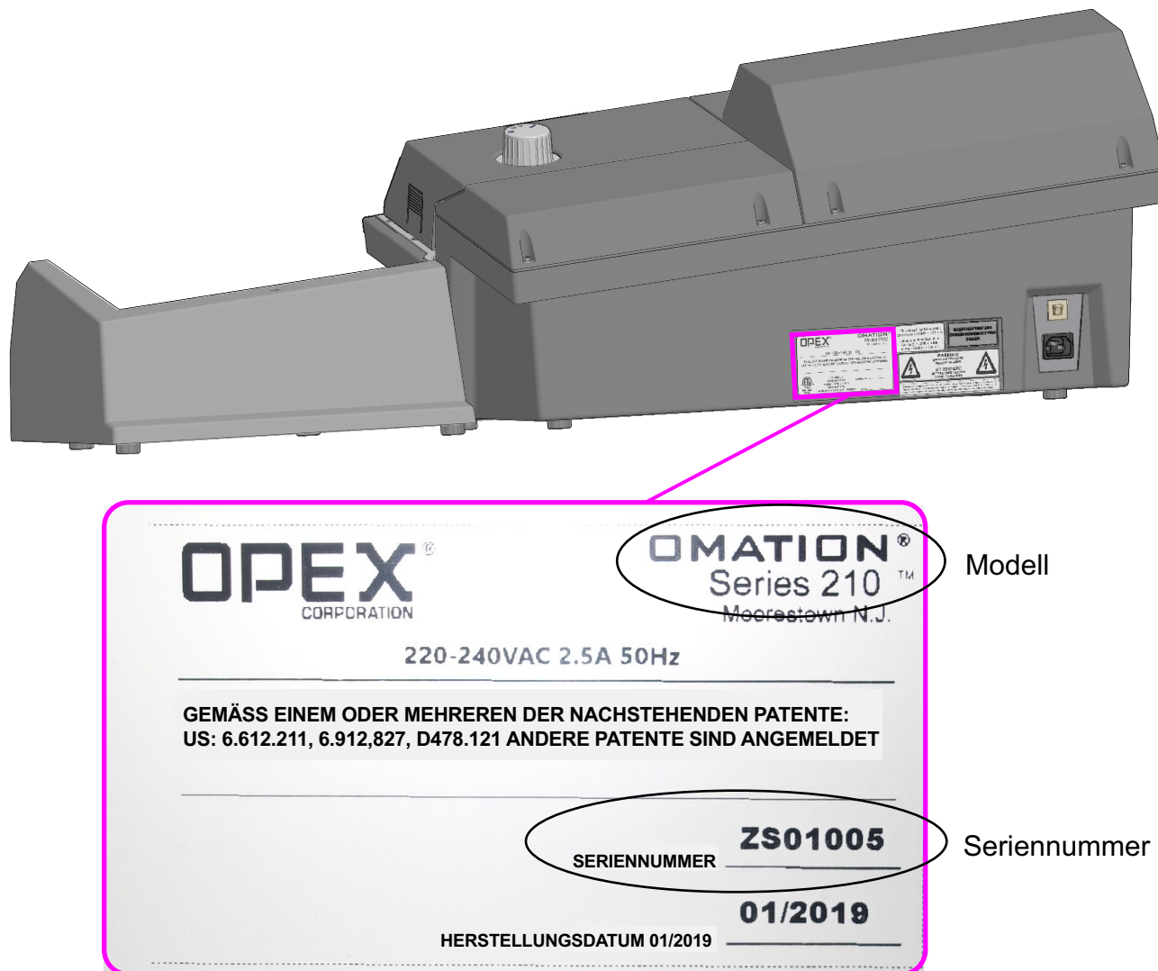
Abbildung 3-2: Schild mit der Modellseriennummer
