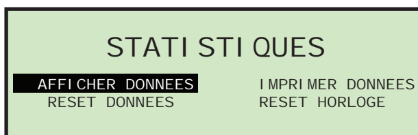
FIGURE 75 : Niveau superviseur - Menu statistiques
