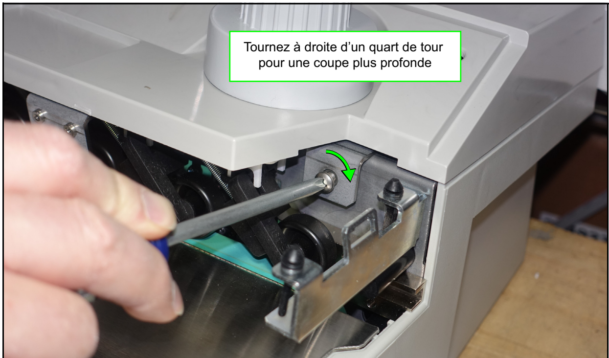
Figure 4-20 : Réglage de la profondeur de la fraise
