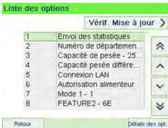
2. Pour afficher les détails d'une option, sélectionnez l'option et appuyez sur **[OK]**.
