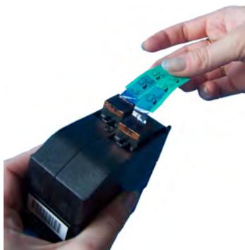
6. Insérez la nouvelle cartouche d'encre en exerçant une pression vers l'avant jusqu'au déclic.
