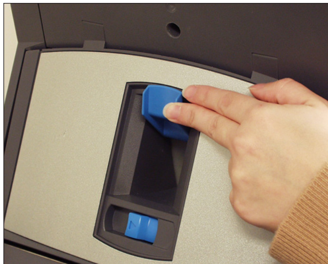
Figura 3.8.1: Elevar la palanca del espacio de separación
