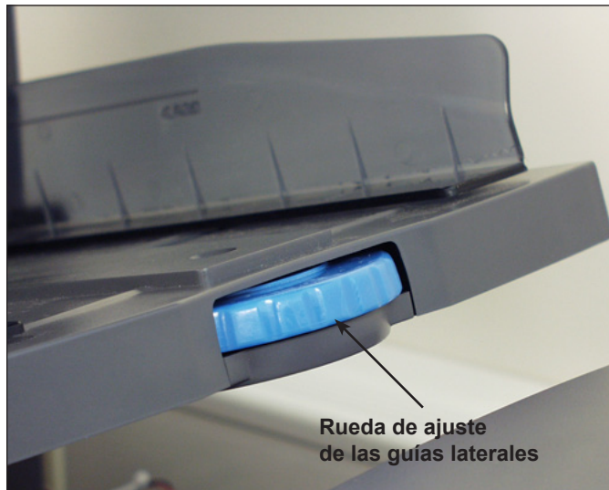
Figura 3.3: Rueda de ajuste de las guías laterales
