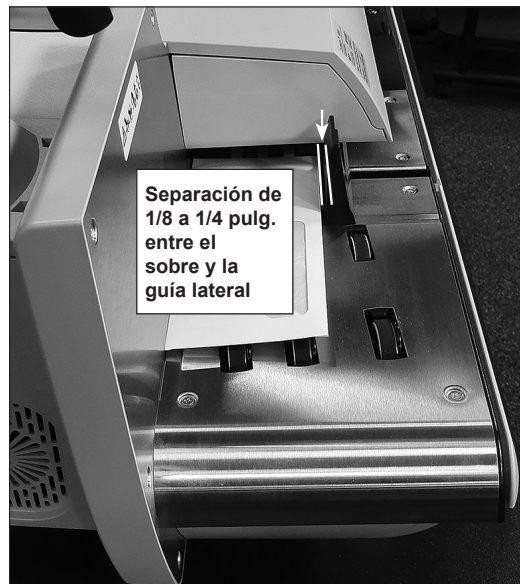
Figura 7.16: Separación entre el sobre y la guía lateral
