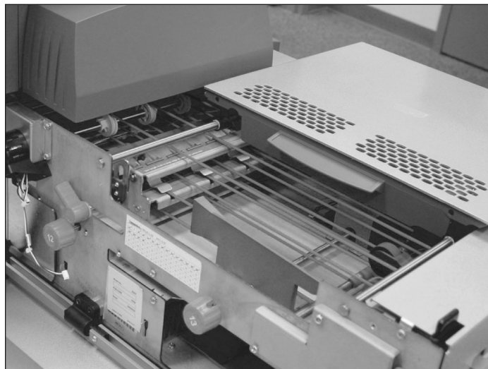
Figura 7.6: Cubiertas frontal y superior del AHAC abiertas
