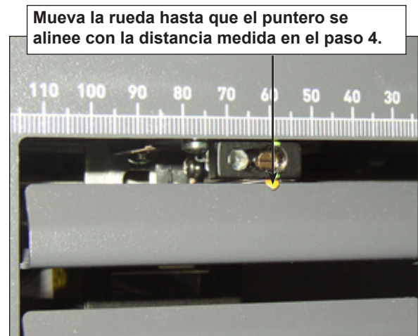
Figura 8.4: Utilice el puntero para asegurarse de que la posición del cabezal de exploración es correcta
