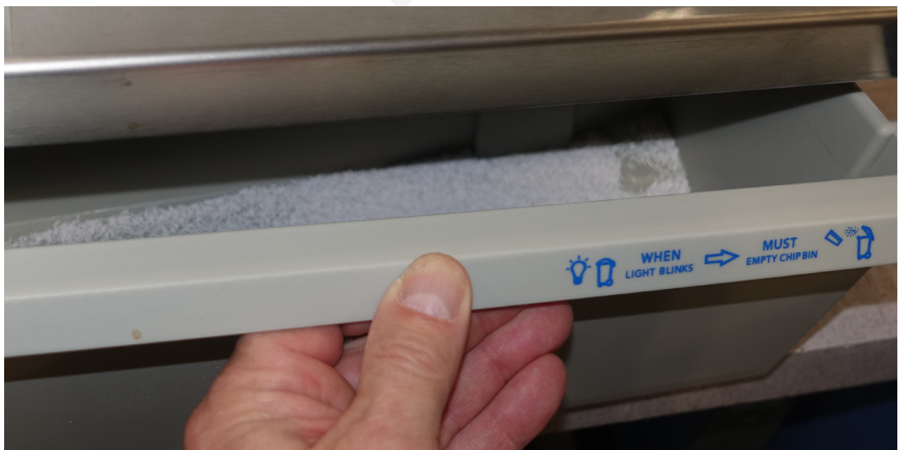
Figura 4-3: Apertura de la bandeja del recipiente de virutas
