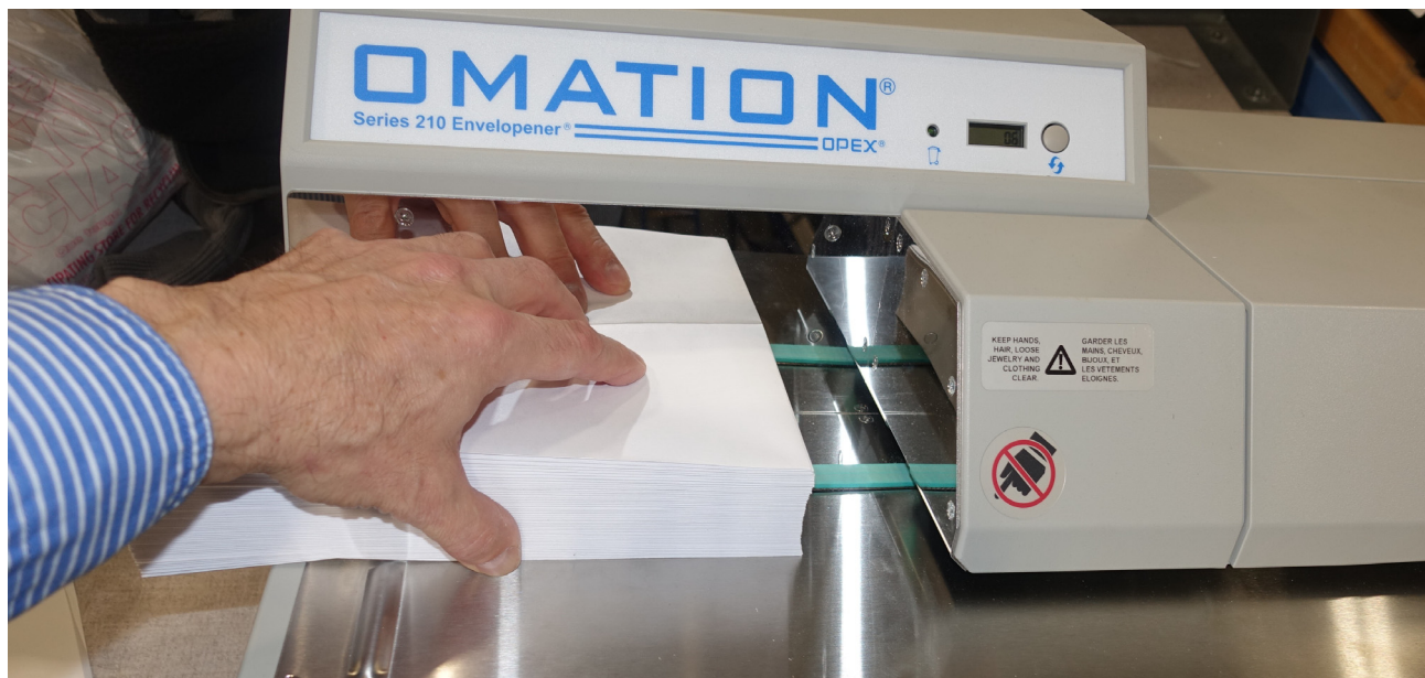
Figura 4-6: Carga de la tolva de alimentación de sobres
