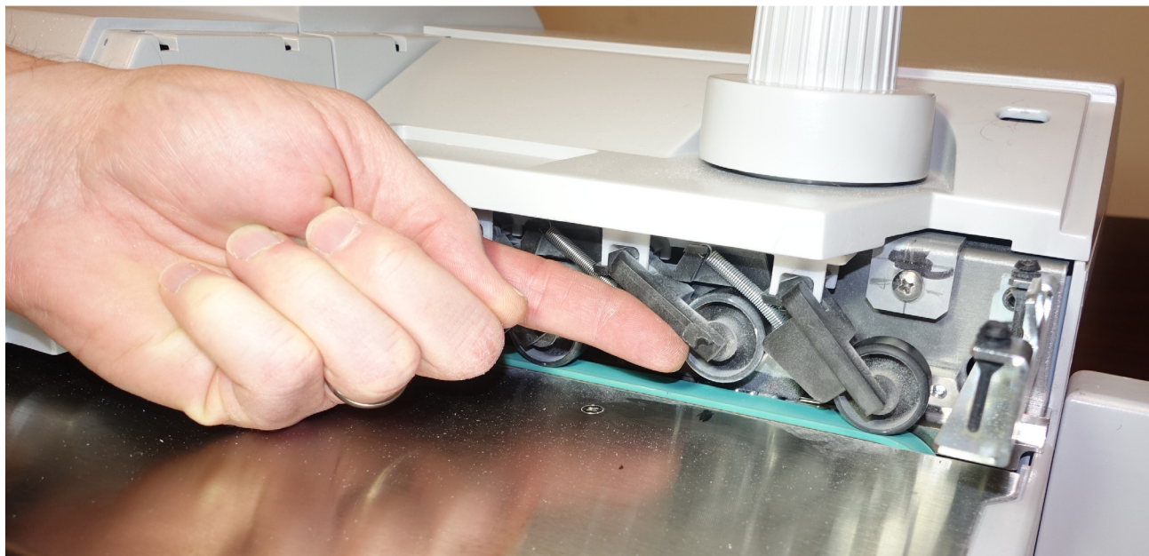
Figura 4-16: Limpieza de las ruedas
