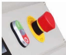
Control de encendido Apagado de emergencia
