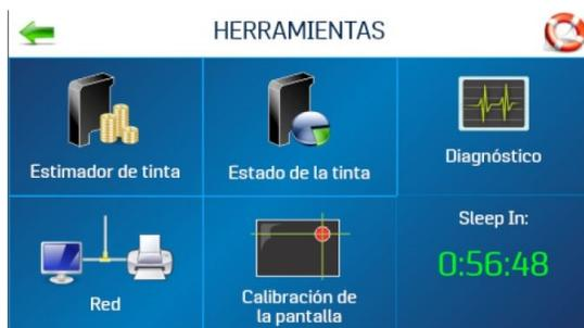
**Calculador de tinta:** Calcula el costo de tinta para un trabajo de impresión en particular. La impresora simula la impresión de hasta 49 páginas del trabajo por imprimir y determina el costo de tinta calculado para todo el trabajo.
