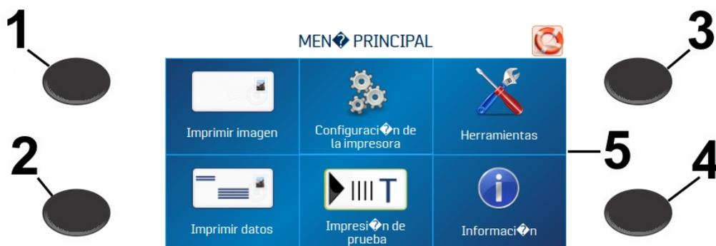
1. **Botón Menú rápido:** Acceso rápido a las siguientes funciones de impresora de uso frecuente: Probar alimentación/reimpresión, Alineación horizontal y vertical, Preferencias de impresora, Impresión de purga y estado de tinta. Presione para abrir. Presione el botón **Menú rápido** nuevamente para salir de la pantalla.
