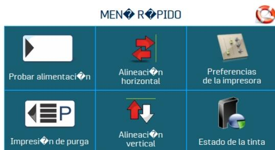
3. Toque la opción **Imprimir** para activar la purga. Al purgar, se imprime un patrón de tinta a 600 ppp que limpia todos los inyectores en todos los cartuchos de tinta. Repita si es necesario.
