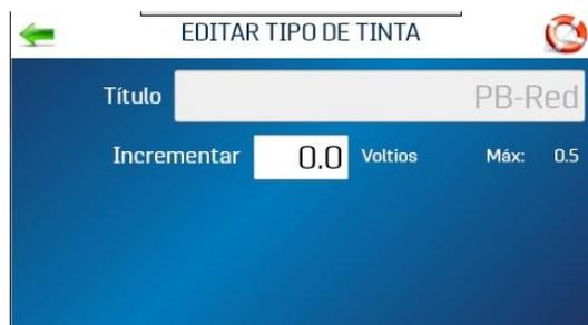
2. Toque el cuadro **Aumentar** para abrir el tablero numérico y aumentar el voltaje de un cartucho de tinta en particular. **NO aumente el voltaje por encima del máximo que se indica en la pantalla táctil.**
