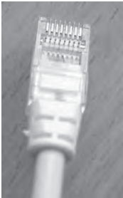
Red / LAN de PC (8 cables)
