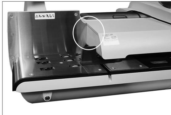
Abbildung 7.15: Seitenführung des Connect+ Frankiersystems (ohne MMI abgebildet)
