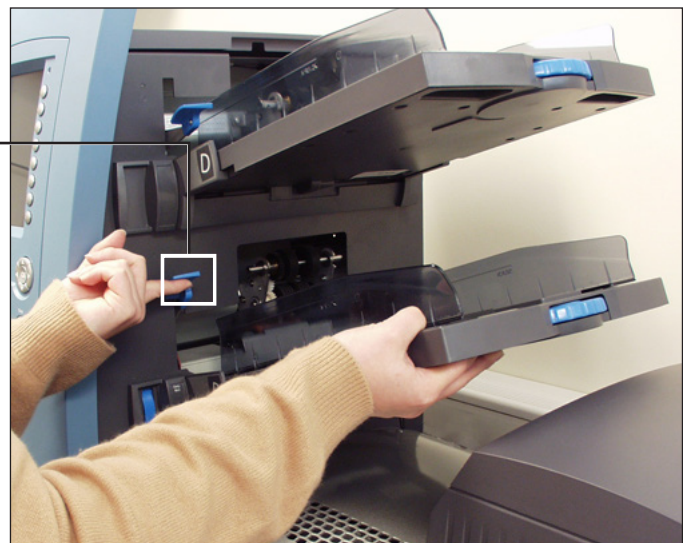
Abbildung 3.1.1: Anheben der Trennvorrichtung und Einsetzen des Fachs in den Aufbau für Blattzuführung
