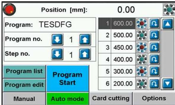
1. **Standartmodus:** Geben Sie einen Wert ein und drücken Sie Start. Der Anschlag bewegt sich automatisch in die eingestellte Position.
