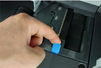
4. Entfernen Sie eingeklemmte Kuverts.
