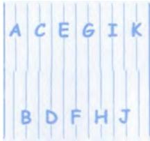
3. Prüfen Sie das Druckmuster, und drücken Sie dann auf den Buchstaben, der der geradlinigsten und vollständigen vertikalen Linie entspricht.
