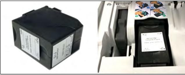
1. Öffnen Sie die Abdeckung: Die Kartusche bewegt sich an die Position, an der die Entnahme erfolgen soll.
