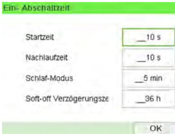
2. Wählen Sie die einzelnen Felder aus, und geben Sie die Länge der einzelnen Ein-/Abschaltzeiten an (mit Hilfe von [C] löschen Sie die Ziffern).
