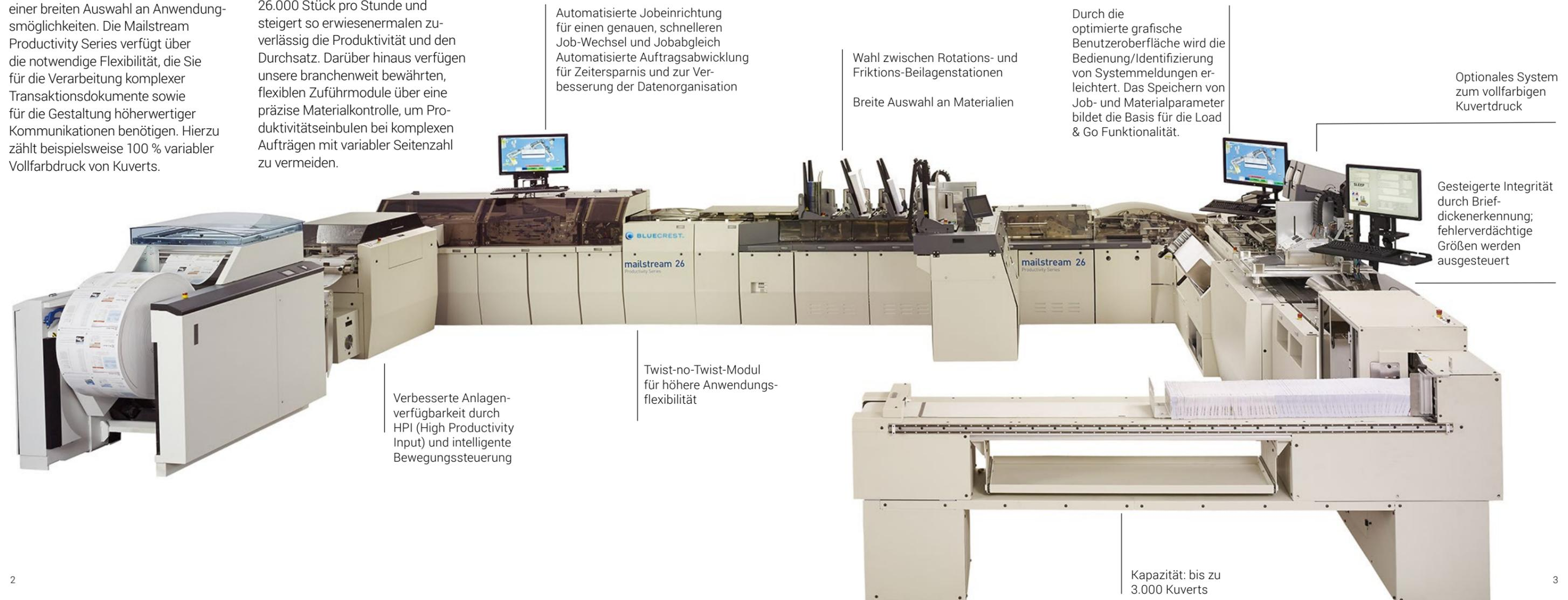
Automatisierte Jobeinrichtung für einen genauen, schnelleren Job-Wechsel und Jobabgleich
