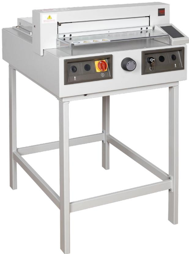
Leistungsstarke Tischmaschine oder als frei stehende Version mit optionalem Tisch zum Schneiden von bis zu 400 Blatt Papier. Geeignet für den Großeinsatz in Büros, Kopierläden, Digitaldruckereien usw.
